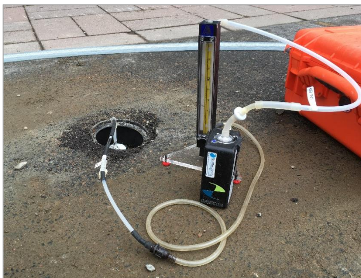
Figur 7. Gasprovtagning i BH/GV4.
