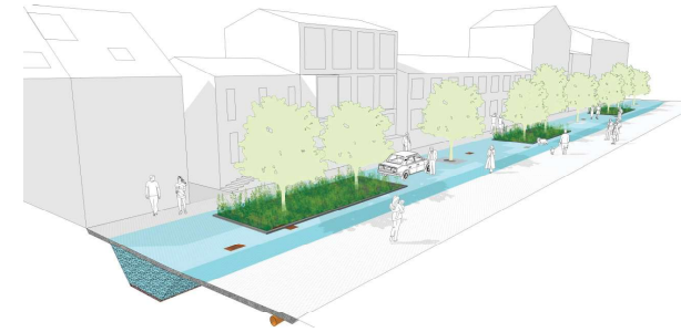
Illustration som visar ett öppet förstärkningslager i gata. Här kan rening och fördröjning av dagvatten kombineras med vegetation. Lednignar och körbanor placeras i separat yta intill.
