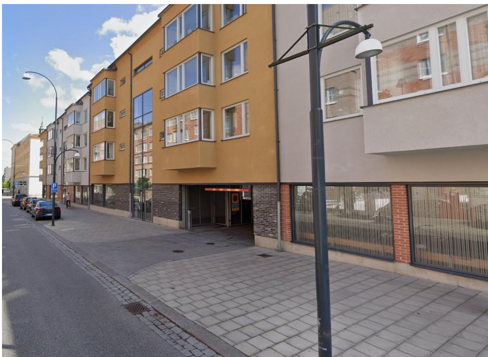
Figur 9. Exempel på parkering i markplan med bostäder ovanför i centrala Eskilstuna (källa: Google Maps).
