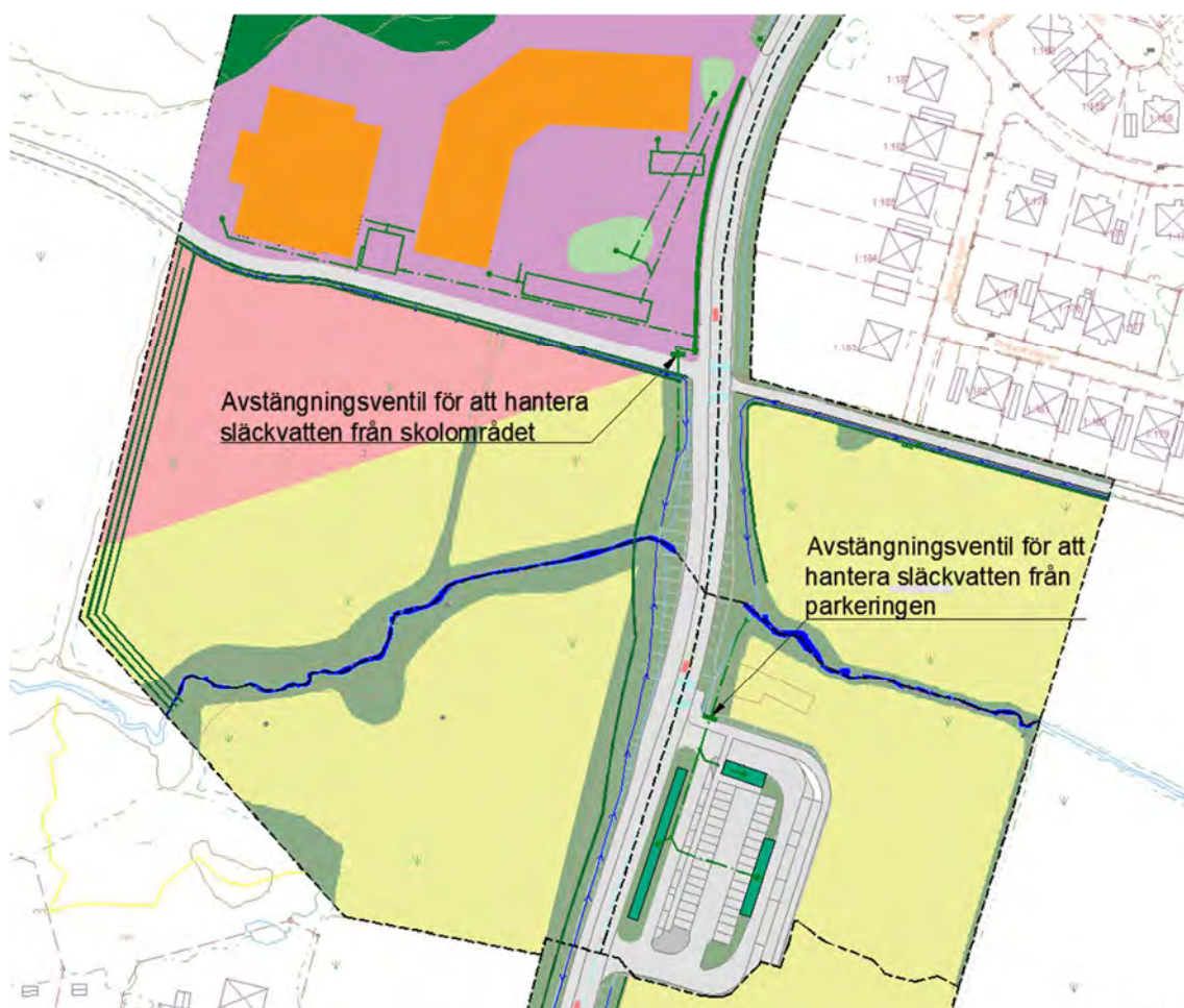
Bild 20: Placering avstängningsventiler för släckvattenhantering.
