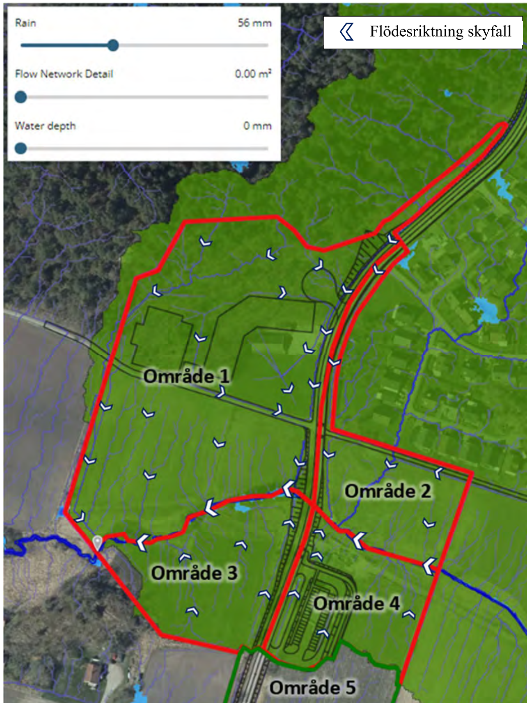
Bild 23: Skyfallsavrinning delområde 1-4. 56 mm regn, bearbetat utdrag ur SCALGO Live, visar översvämmade ytor och avrinningsområde vid skyfall.
