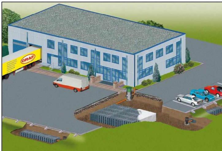
Figur 46. Exempel på utjämningsmagasin bestående av dagvattenkassetter (Uponor)
