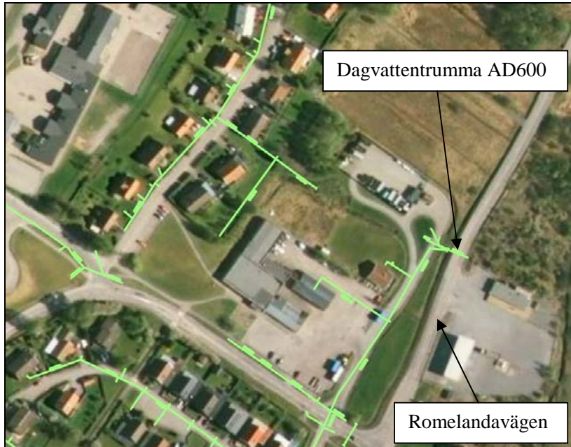
Figur 13. Kartbild över ledningssystem samt befintlig dagvattentrumma som avvattnar stora delar av Diseröd till Välabäcken
