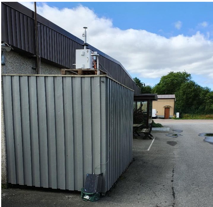
Figur 3. Mätutrustningens placering cirka 3–3,5 m ovan mark.
