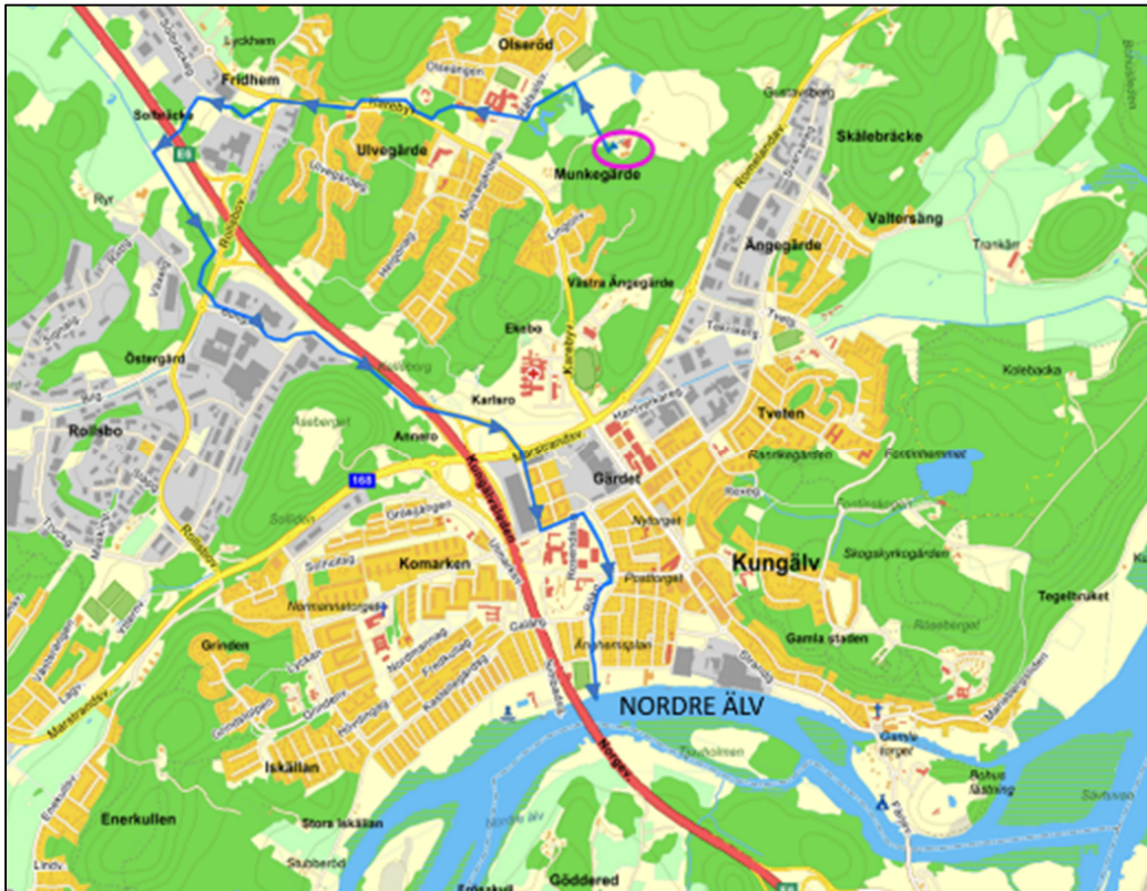
Figur 6. Komarcksbäckens väg från Munkegårdeverket till vattenförekomsten Nordre älv är markerat med blå linje. Sträckan går omväxlande genom öppna diken och kulverteringar. Blå pilar visar flödets riktning från Munkegårdeverket till recipienten. (bild hämtad från WSP:s dagvattenutredning)
