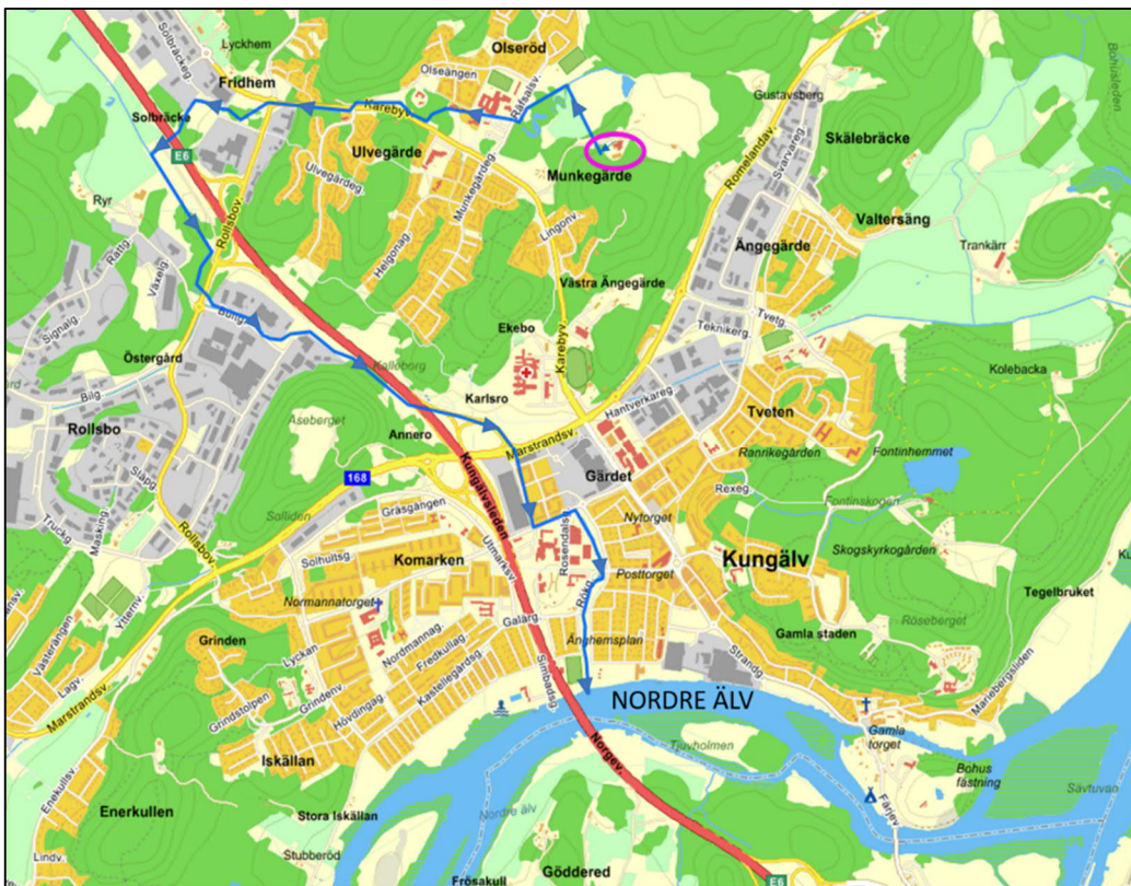
Figur 12. Planområdet är markerat med rosa cirkel. Vattenväg från utredningsområdet till vattenförekomsten Nordre älv är markerat med blå linje. Sträckan går omväxlande genom öppna diken och kulverteringar. Blå pilar visar flödets riktning från Munkegärdeverket till recipienten.
