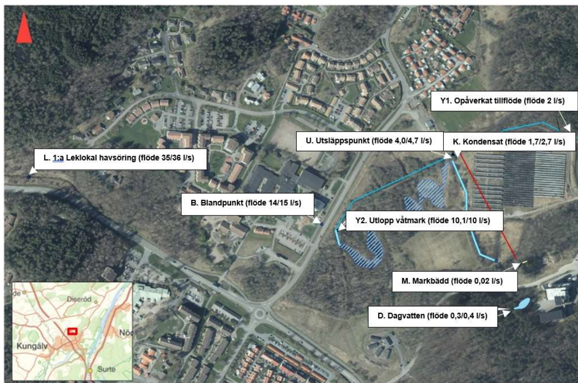
Figur 14 Utsläppspunkter (D, M, Y2, Y1, K) och blandpunkter (U, B, L) för bedömning av miljöbelastning i Komarksbäcken. Flöden före och efter utbyggnad av värmeverket.
