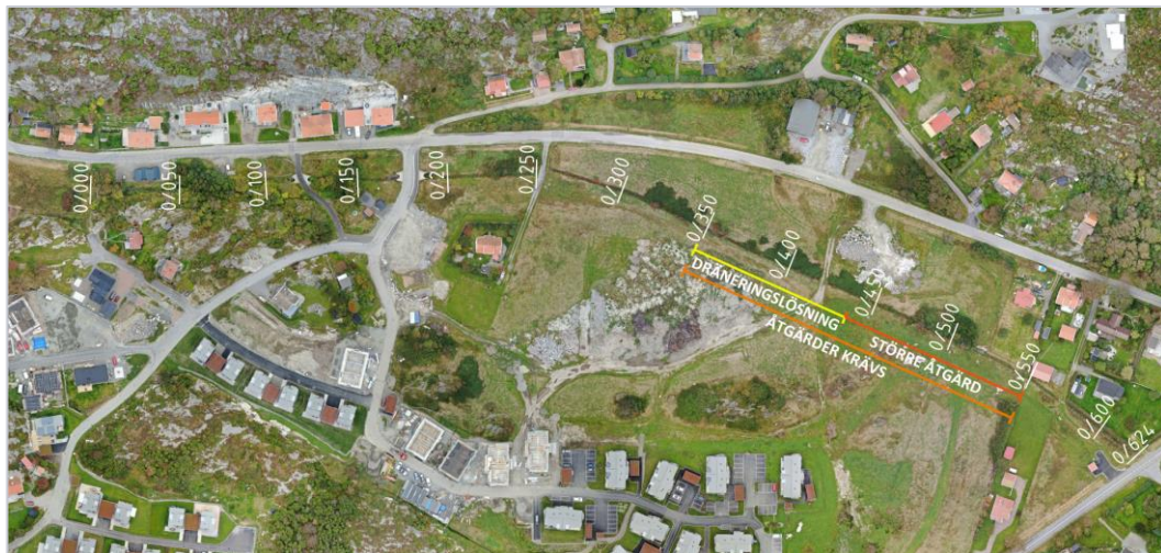
Figur 8. Längdmätning för Tjuvkils dike från utlopp (0/000) till väg 168 (0/624). Den sträcka där åtgärder krävs p.g.a. instabila markförhållanden 0/350-0/550 har markerats.
