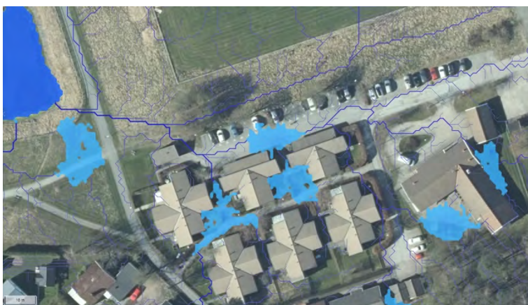
Bild 16: Kabbelekan vid 100 års regn, efter exploatering och anläggande av kompletterande utjämningsvolym samt avskärande dike, enligt bilaga 3.
