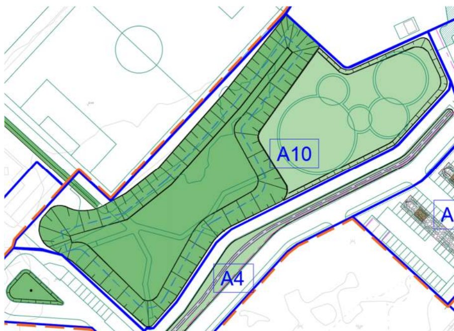
Bild 16: Område A10 omfattar grönområdet och skatepark. Till en stor öppen fördröjningsyta i grönområdet leds allt dagvatten från uppströmsområdena samt större delen av planområdet.
