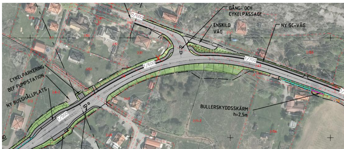
Figur 7. Föreslagen utformning av korsningen mellan väg 168 och väg 612 (Tjuvkils vägskäl). Bild hämtad ur vägplanens granskningshandling.
