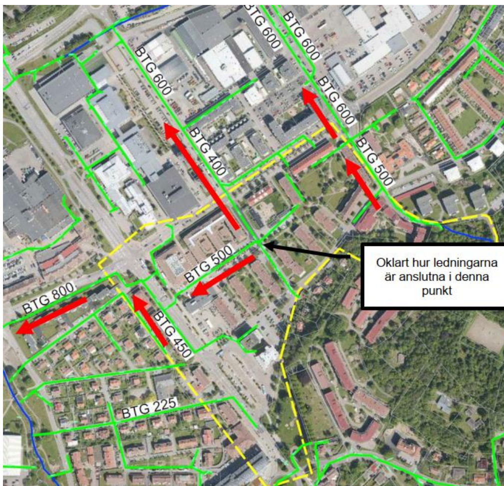
Figur 12. Befintliga dagvattenledningar och relevanta huvuddimensioner framgår av figuren. Röda pilar visar flödesriktning i ledningar.
