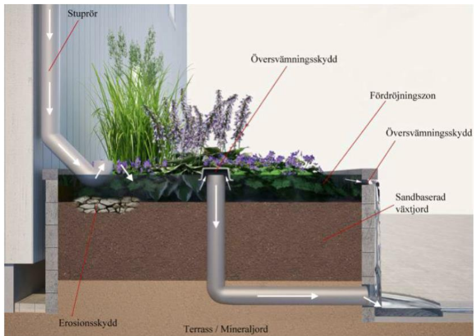
Figur 20. Principskiss över regnbädd som omhändertar takvatten. Källa: Movium fakta #2 2015 (Illustration Tengbomgruppen).
