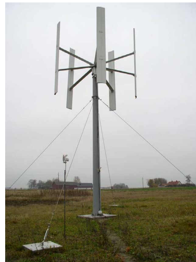
Ett exempel på vertikalt vindkraftverk ca 10 m högt.
