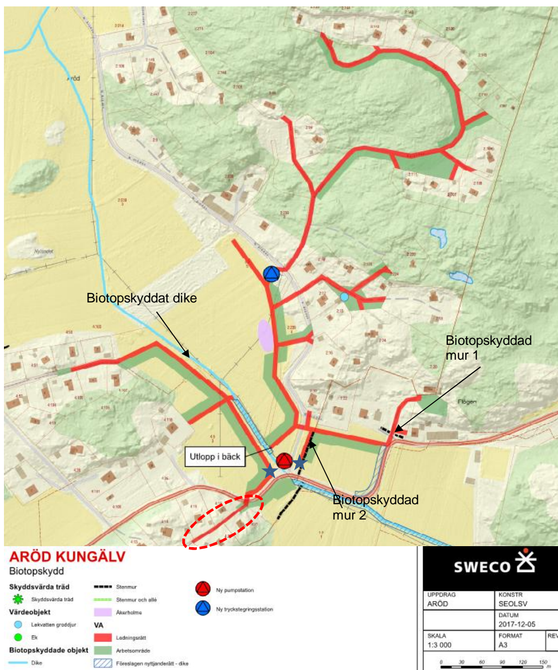
Figur 3. Föreslagna ledningstråk med arbetsområde samt biotopskyddade objekt. Röd streckad cirkel visar område där ledning föreslås tryckas/borras. Blå stjärnor visar vart projektet ansluter till befintliga ledningar.
